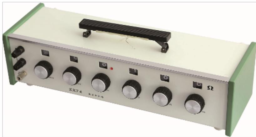
交流电阻箱的使用：使用时，把两个接线柱接入电路，各旋盘对应的指示点的示数以面板上标出的倍数，然后加在一起，就是接入电路的阻值。直流电阻箱顾名思义就是只适用于直流测试领域；交流电阻箱则适用于交流阻抗测试领域。通常情况下标准直流电阻为达到一定的精度要求，都采用绕线电阻，如果只用于直流测试，则无感抗分量的影响能保证精度，如果用于交流测试则感抗分量会随着频率的升高而增大，影响测试的精度，因此一般来说标准直流电阻（箱）的频率范围都很低。广东可变电阻箱销售上海双特电阻箱的运用领域。
