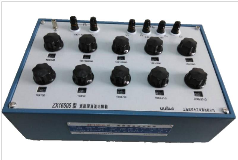
每一个电阻元件均接于开关上各个触点之间，两接线柱之间的电阻值可以通过改变开关电刷位置而得到各种阻值。开关采用复银金属的电刷和接触点，接触压力小、寿命长、变差小，支座采用绝缘塑料制成，整机绝缘电阻高。面板上读数示值排成二条直线，简捷而清晰，电阻器无零位，起始电阻值是 $0.01\Omega$ 。使用过程中对测量值不必扣除零电阻，使用方便。ZX54直流电阻箱适合于工矿企业，学校和科研单位作电测量和其它实验之用。接触压力小、寿命长、变差小，支座采用绝缘塑料制成，整机绝缘电阻高。ZX54型为七个十进开关串联而成的实验室型多值电阻器。使用电阻箱到底有什么好处？广东可变电阻箱销售
