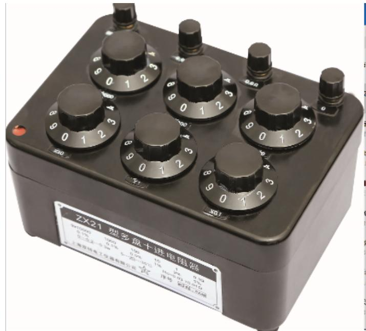
电阻箱内电阻线的绕法不同，就出现了直流电阻箱和交流电阻箱的区别，直流电阻箱适用于直流电路，或者对交流成分不敏感的交流电路用；交流电阻箱交直流电路都可以用。电阻箱内的电阻都是用锰铜线绕成的，它就类似一个空芯的电感线圈，虽说有些电感量，但应用于直流电路影响不大，但应用于交流电路还是有影响的，如在交流电桥中，就必须尽可能的减小它的电感量，减小方法是把电阻线在中心点对折，再进行双线并绕，这样通过双线的电流，一半是左旋一半是右旋，所产生的磁势互相抵消，电感量就会很小很小。
